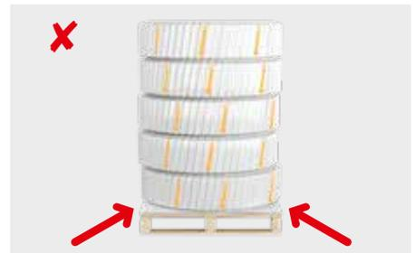
Manuseie os rolos evitando choques e raspagem. Coloque uma placa de cartão ou algo semelhante entre a superfície da paleta e o primeiro rolo. Coloque os rolos na paleta com ambas as extremidades dos tubos flexíveis viradas para cima.
